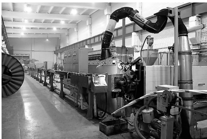
Кабельный цех. Линия по изготовлению силового кабеля
